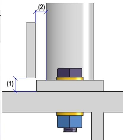
Spécifiez sous **Montage**, en cochant la case correspondante si les plinthes doivent être utilisées partout ou seulement au niveau du palier, c'est-à-dire seulement dans la zone horizontale avec une coupe au niveau de la zone oblique.
