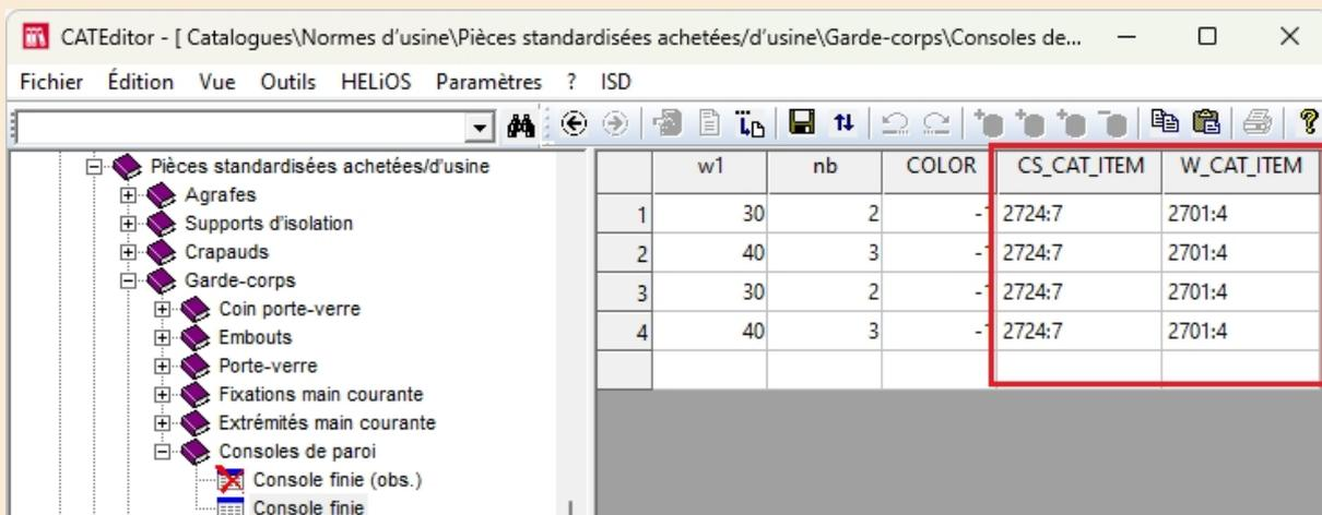
La première valeur est toujours l'ID du tableau, la seconde l'ID du code de données correspondant. Les deux valeurs sont séparées par deux points. Par exemple, **2724:7** représente le tableau **DIN 66** sous **Usinage, général > Usinage > Fraisages** et le code de données avec l'ID 7. Si vous double-cliquez avec la souris dans l'une des colonnes, vous pouvez sélectionner directement le tableau et le code de données souhaités.
