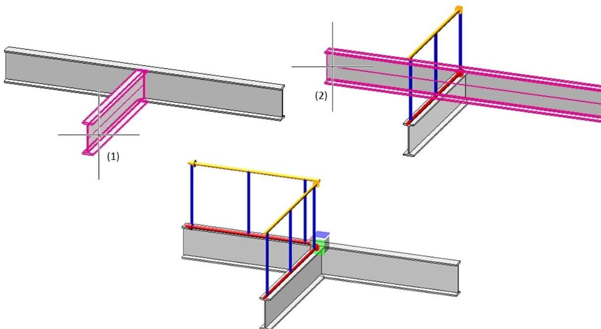
À la sélection des profilés, la ligne de foulée et la direction de la foulée est signalée par une flèche rouge. En fonction de cette ligne de foulée, la hauteur du garde-corps est déterminée ainsi que la position des fixations. La répartition des poteaux, de même, sera visualisée également en se basant sur les derniers paramètres sélectionnés. Dès que vous modifiez les paramètres dans la fenêtre de dialogue du configurateur de garde-corps, l'aperçu sera actualisé.
