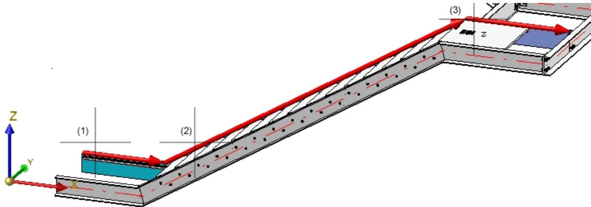
2. Les paramètres du garde-corps de l'étape 1 sont encore disponibles dans la fenêtre de dialogue du configurateur de garde-corps. Les profilés de tous les escaliers sont de même type, nous n'avons besoin de modifier que ceux de l'onglet **Répartition de poteau**.
