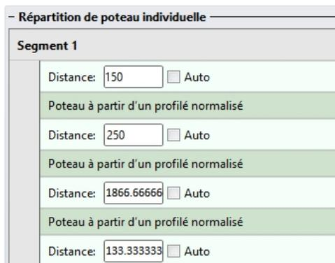
Insérer maintenant dans le Segment 1 deux nouveaux poteaux. Sélectionner pour ce faire la fonction **Nouveau poteau, via point** et déterminer le point souhaité pour le nouveau poteau.
