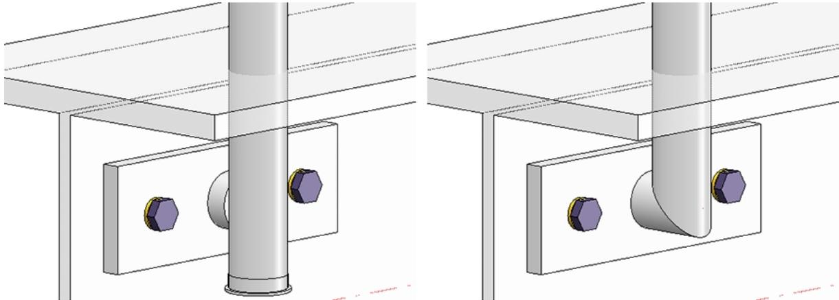
À gauche : avec élément de distance (tronqué) et embout de poteau. À droite : Profilé de poteau en onglet
