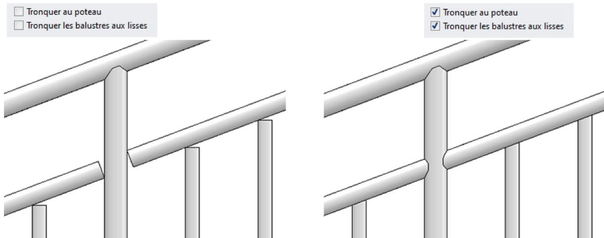
Balustres verticaux avec lisses, sans et avec tronçage
