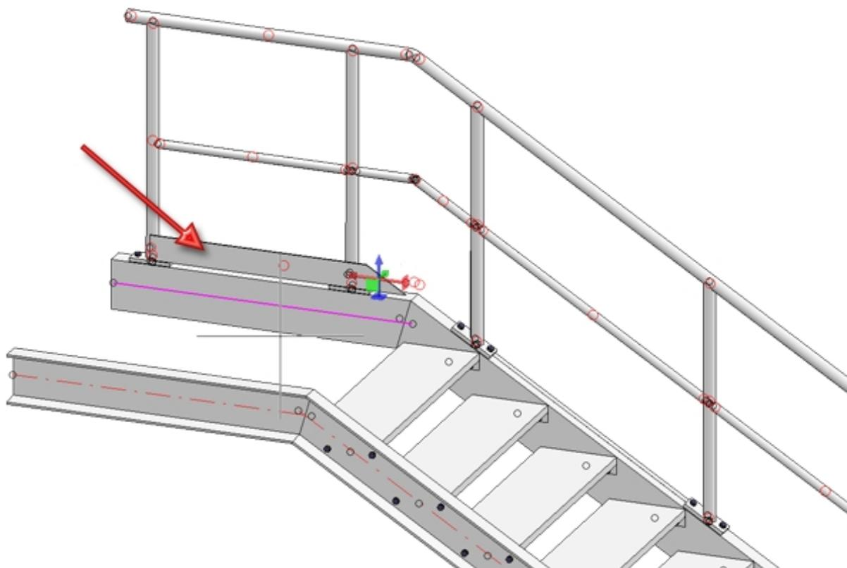
Déterminé sous **Espace en bas** la distance entre la plinthe et l'arête supérieure de la poutre (1) ainsi que la distance par rapport au poteau (2) :
