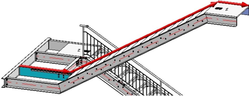
2. Les paramètres du garde-corps de l'étape 2 sont encore disponibles dans la fenêtre de dialogue du configurateur de garde-corps . Nous n'avons besoin de modifier que les paramètres de l'onglet **Répartition de poteau**.
