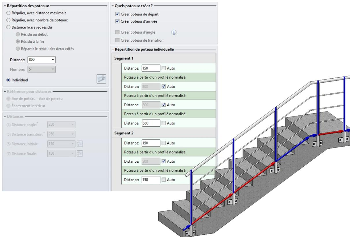
Nous souhaitons déplacer le poteau du Segment , cela au moyen d'un point. Cliquer sur l'entrée correspondant à ce poteau, et sélectionner la fonction **Déplacer les poteaux, via point** (1) et déterminer le point où le poteau doit être déplacé (2). L'aperçu (3) est actualisé.
