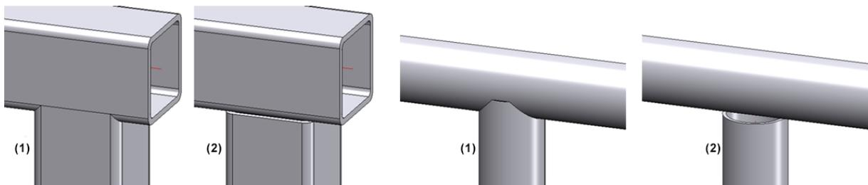
(1) Tronquer tuyau, (2) Tronquer tuyau à l'arête inférieure de la main courante
