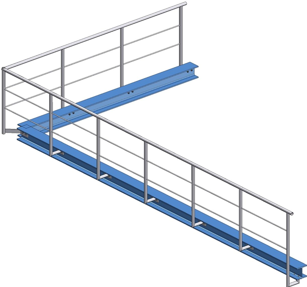
Garde-corps avec jonction latérale pour les poteaux de départ, d'angle et intermédiaire et jonction en dessous pour le poteau d'arrivée
