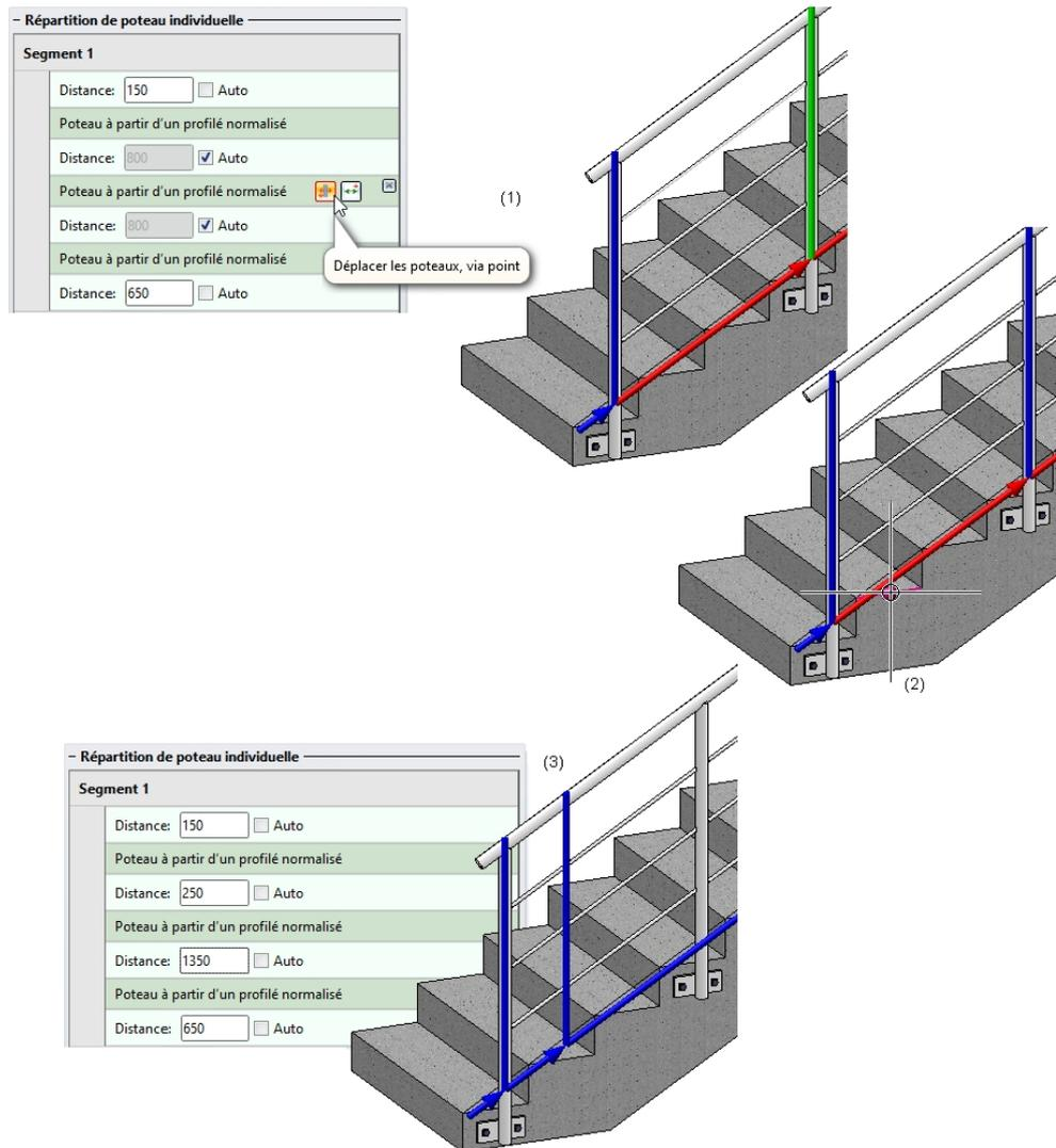
Déplacer maintenant de la même façon le 3<sup>e</sup> poteau du Segment 1. Cliquer sur l'entrée correspondant à ce poteau, et sélectionner la fonction **Déplacer les poteaux, via point** (1) et déterminer le point où le poteau doit être déplacé (2). L'aperçu (3) est actualisé.
