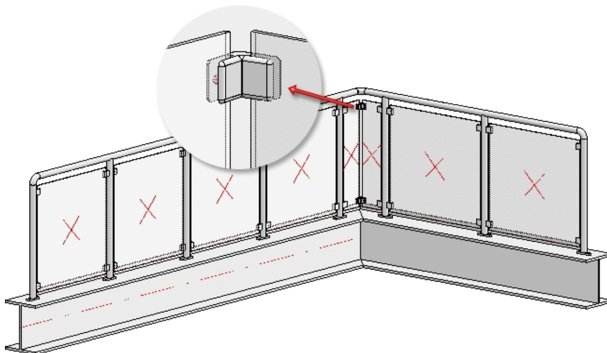
Exemples d'un garde-corps en verre avec remplissage d'angle individuel
