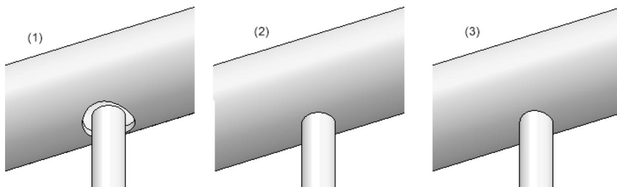
(1) Insertion dans la main courante avec espace, (2) Ne pas tronquer, (3) Tronquer avec contour
