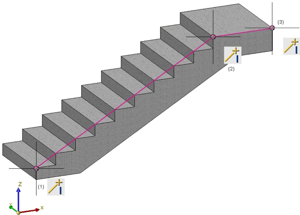
Après le lancement du configurateur de garde-corps (le long des arêtes), identifiez les deux arêtes de l'esquisse 3D. Par un clic sur la molette, la fenêtre de dialogue de la macro du garde-corps s'ouvre. Pour l'exemple, nous utilisons les paramètres par défaut prédéfinis par ISD, excepté pour l'onglet **Ligne de foulée**, **Répartition de poteau**, **Remplissage** et **Poteau - Sous-structure** que nous modifions comme ci-dessous.
