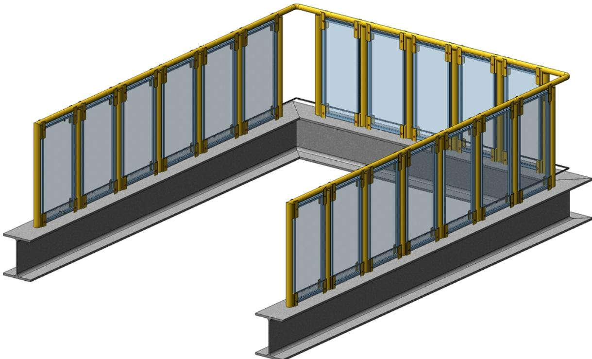
*Exemple d'un garde-corps sur un escalier à plusieurs étages*
