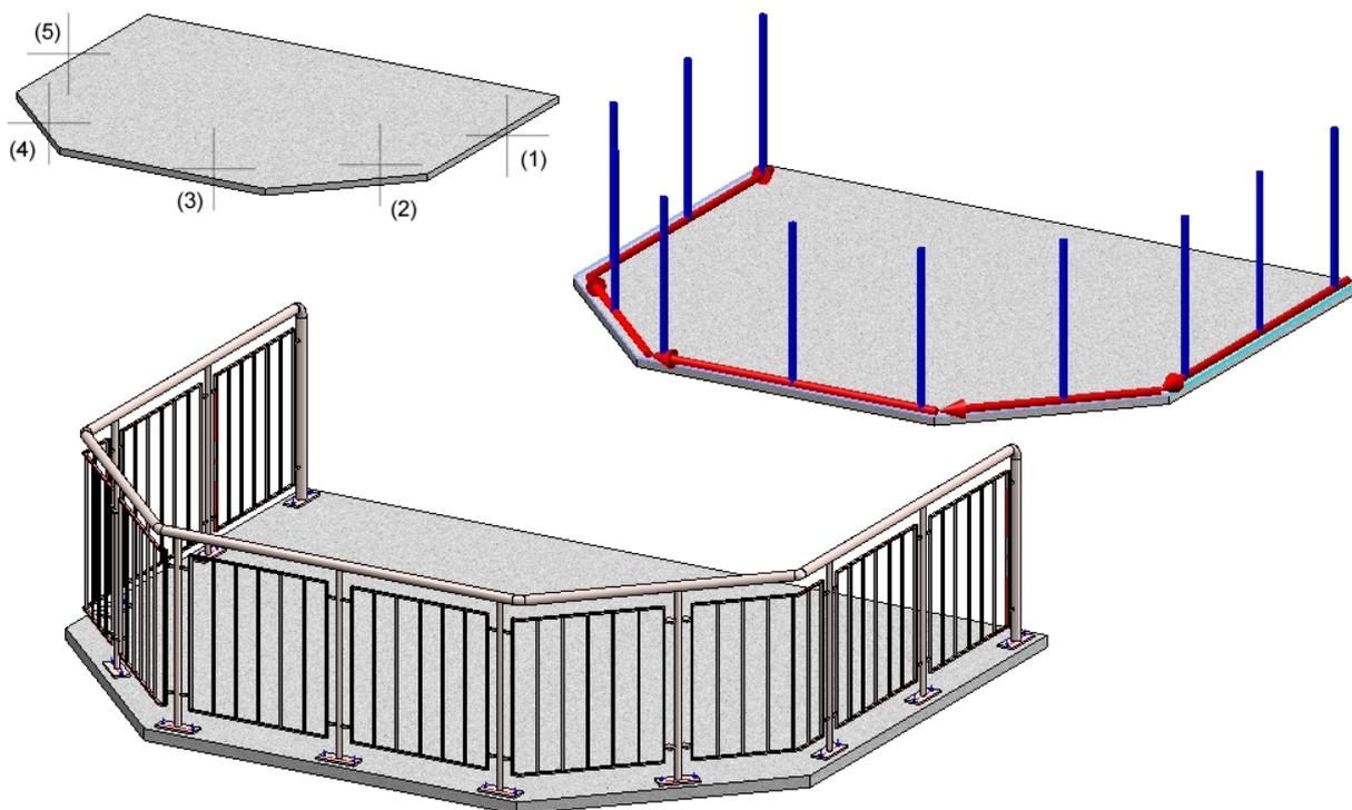
En haut : Solide 3D avec les arêtes sélectionnées (1) à (5). En bas : Exemple d'un garde-corps
