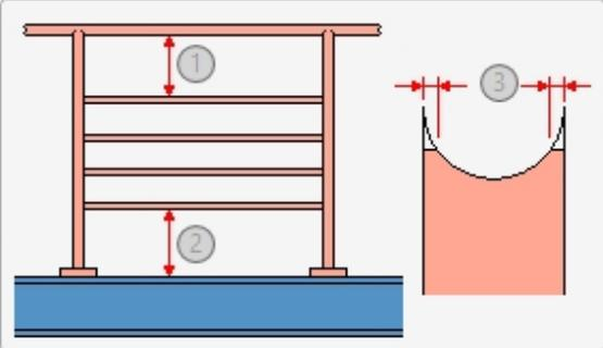
Sous-lisse: Tuyau DIN 2448 13.5x2.9 - S235JR
