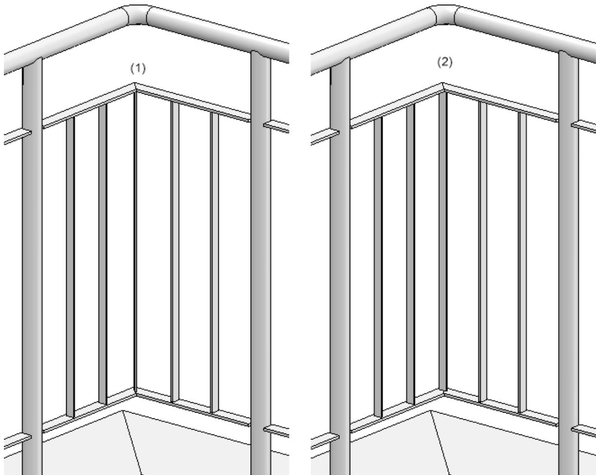
Exemple d'un remplissage d'angle : (1) Balustre d'angle, aligner à la bissectrice, (2) Balustre d'angle, ne pas aligner à la bissectrice
