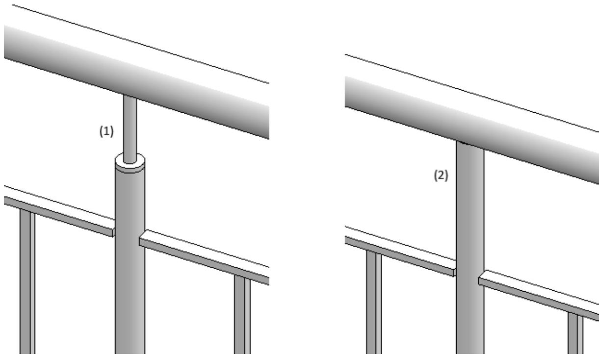
Exemple 2 - Connexion Poteau intermédiaire-Main courante : 1) Connexion avec mandrin, (2) Tronquer tuyau
