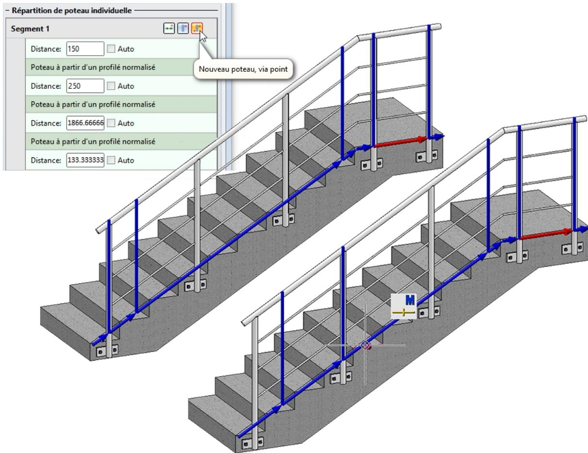
La fonction **Nouveau poteau, via point** reste active, permettant de déterminer directement la position du deuxième nouveau poteau.
