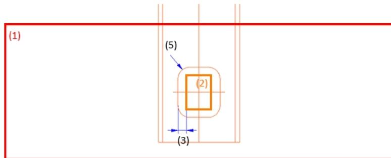
(1) Platine de base, (2) Élément de distance, (3) Jeu de coupe, (4) Offset, (5) Rayon d'angle
