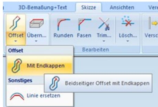
Der eingegebene Offset wird dann auf beide Seiten des Kantenzuges addiert. Möchte man also eine Blechdicke von 1mm erreichen, muss ein Offset von 0.5 eingegeben werden.
