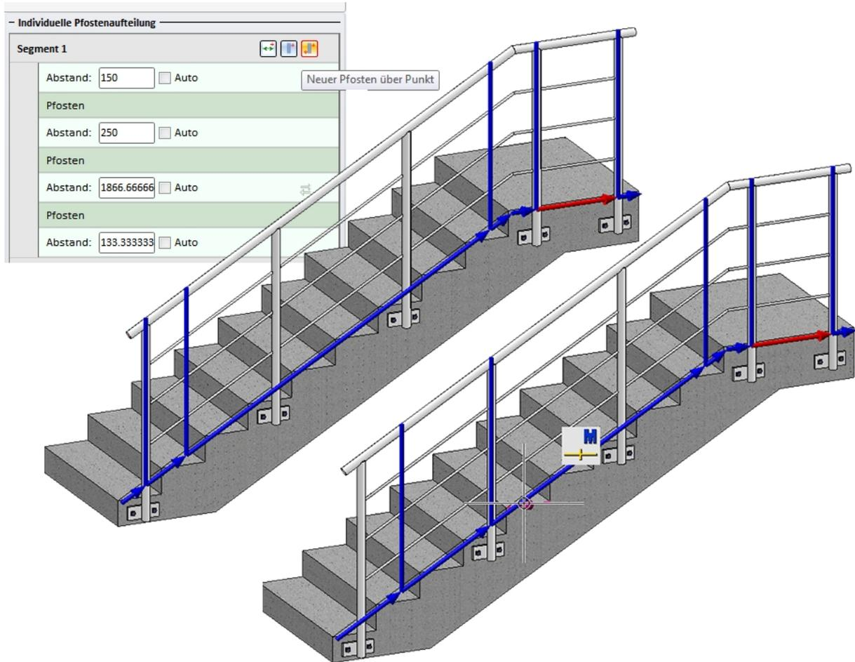
Die Funktion **Neuer Pfosten über Punkt** bleibt aktiv, so dass direkt die Position des zweiten neuen Pfostens bestimmt werden kann.
