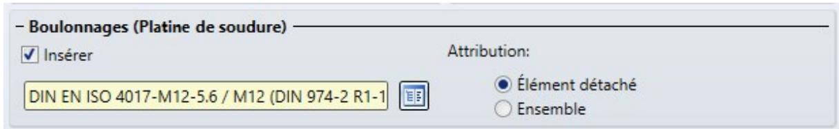
En cochant la case **Insérer**, la fixation est alors effectuée au moyen d'un boulonnage encastré par le bas dans la platine de soudure, c'est-à-dire qu'ici, seules la platine de soudure et la platine de base sont vissées ensemble.
