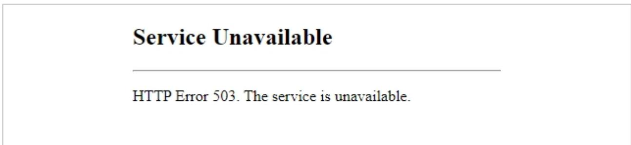
prüfen Sie bitte, ob der Applikationspool für den HELiOS API Server läuft oder beendet wurde. Sie erkennen dies am Icon bzw. der Statusanzeige im IIS Manager:
