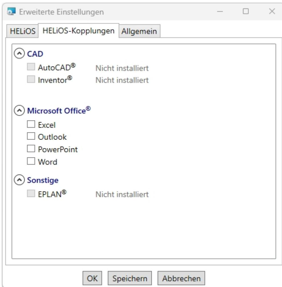
Die Auswahl zur Kopplung mit HELIOS hängt von den Programmen ab die auf Ihrem Computer installiert sind. Dabei können Sie nur 64 Bit Versionen mit HELIOS (64 Bit) verknüpfen. Eine Mehrfachauswahl ist bei der HELIOS-Kopplung möglich. In den gekoppelten Programmen werden die HELIOS-Funktionen integriert.
