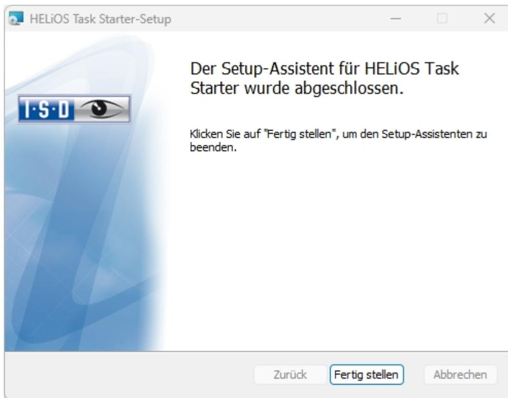
Nach der Installation muss der **HELiOS Task Starter** konfiguriert werden (siehe HELiOS Onlinehilfe). Dazu bearbeiten Sie die Datei **TaskStarter.config** (%programdata%\ISD Software und Systeme\HELiOS Task Starter <Version>\). Danach tragen Sie den Dienst in die Windows-Aufgabenplanung ein. Bei Fragen wenden Sie sich bitte an das ISD-Consulting.
