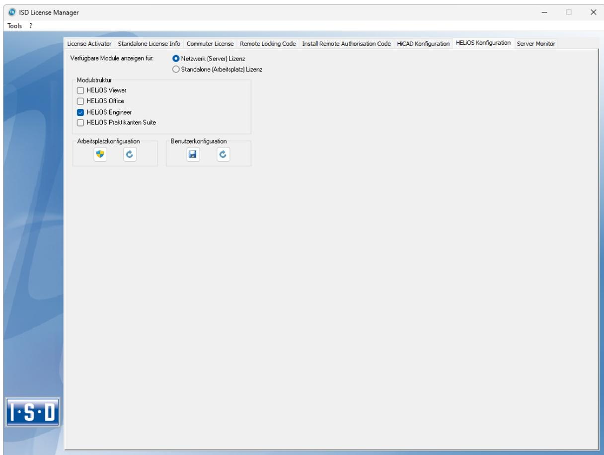
Auf der Registerkarte **HELIOS Konfiguration** des **ISD License Manager** besteht die Möglichkeit eine Arbeitsplatz- bzw. Benutzerkonfiguration für einzelne Clients abzulegen.
