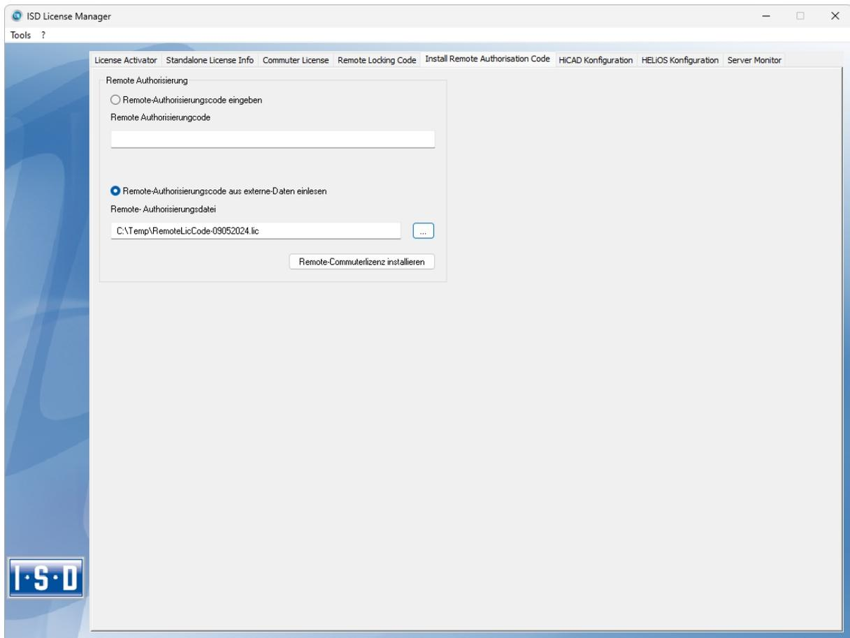
Hier kann der Client die erhaltenen Commuterlizenzen direkt mit der Auswahl der Datei oder durch Kopieren der Dateiinhalte installieren. Mit der Schaltfläche **Remote Commuterlizenz installieren** werden die Commuterlizenzen auf dem Client installiert.
