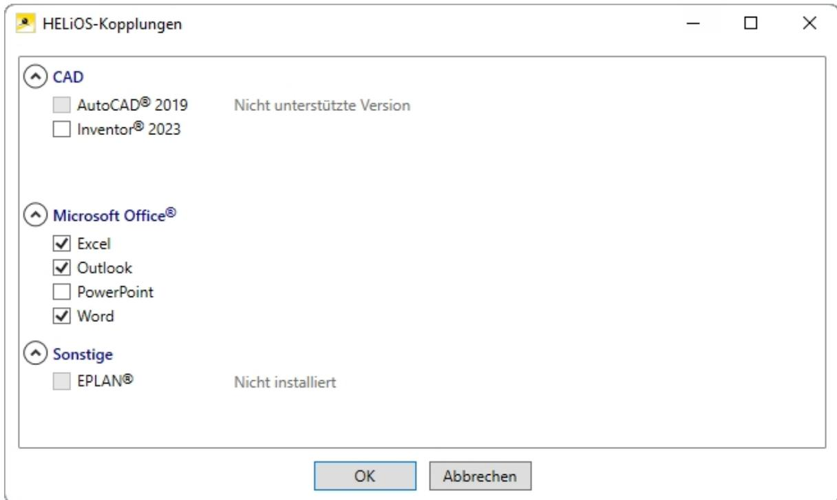
Aktivieren Sie die Checkbox der gewünschten Software und bestätigen mit **OK**. Die Kopplung wird daraufhin aktiviert.
