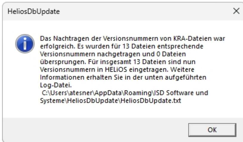
Nach der Übertragung finden Sie das Protokoll mit weiteren Informationen im angezeigten Pfad. Sollte die Übertragung fehlschlagen, müssen Sie das Tool erneut über die Kommandozeile **HeliosDbUpdate.exe /CheckKraVersion** aufrufen.
