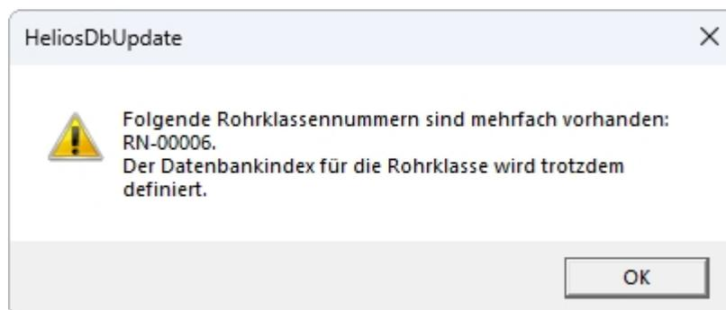
Um die Eindeutigkeitsprüfung von der Rohrklassennummer (RKLname) unabhängig zu machen, wird für alle Objekte in der Datenbank ein unique-Index vergeben. Hintergrund ist, dass im HELiOS nie der Pfad der Objekte berücksichtigt wird.
