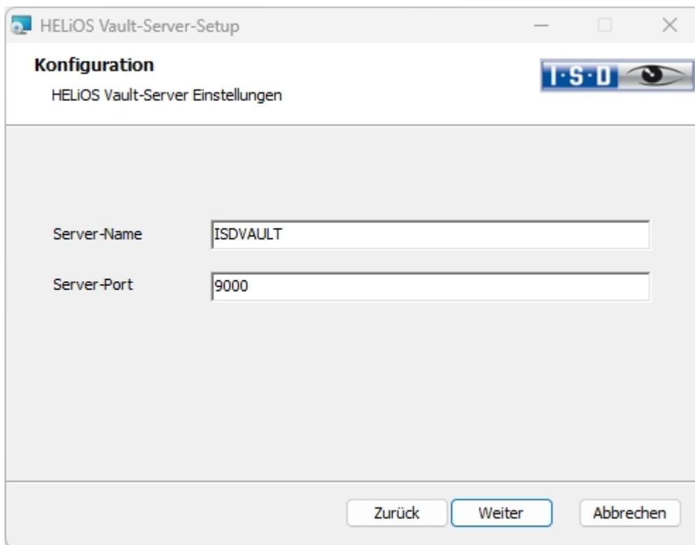
Geben Sie dem HELiOS Vault-Server einen Namen z. B. den Firmennamen kombiniert mit dem Standort. Dieser Name wird Ihnen z. B. angezeigt, wenn Sie sich vom **Vault-Client** mit dem **Vault-Server** verbinden.
