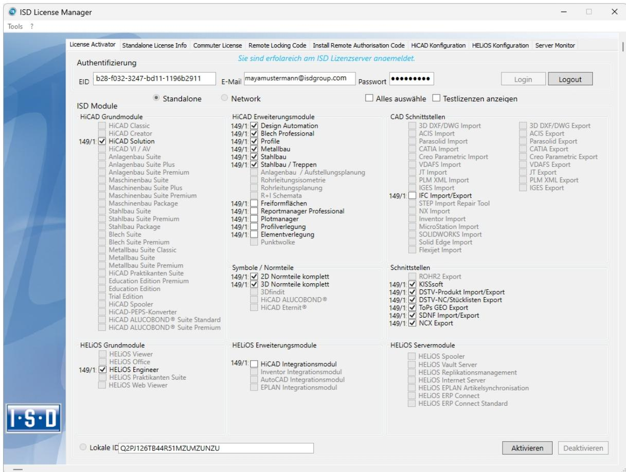
Wählen Sie die freizuschaltenden Module aus und starten sie die Freigabe mit **Aktivieren**. Bei einer Serverlizenz sind die Module bereits ausgewählt.
