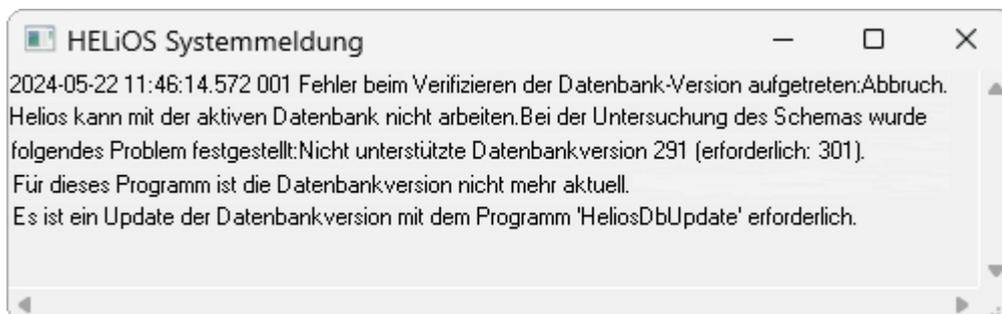
Mit dem Programm **HeliosDbUpdate.exe** aktualisieren Sie das Datenbankschema.
