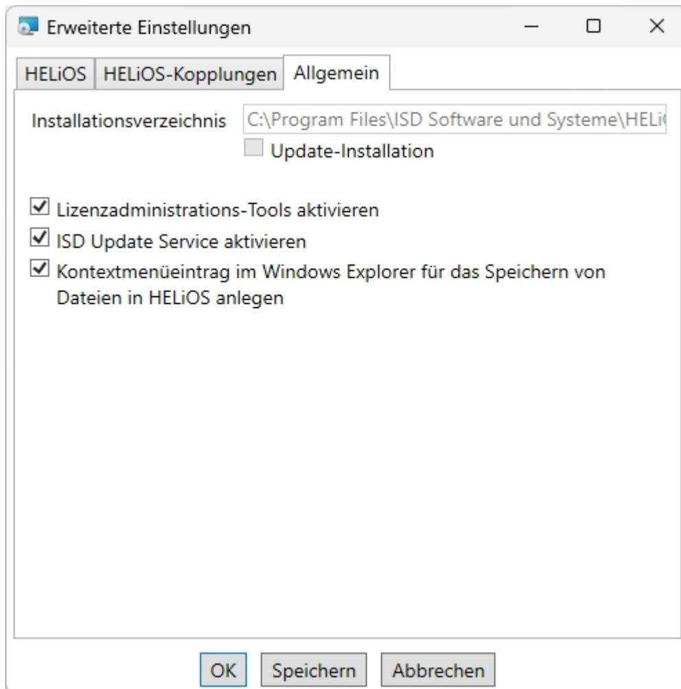
Bei der Update-Installation entscheiden Sie sich durch die Aktivierung der Option **ISD Update Service aktivieren** für die Suche nach einem Hotfix auf dem ISD-Webserver beim Programmstart von HELiOS. Sie können diese Option auch nachträglich über die Systemsteuerung aktivieren. Wählen Sie in der Systemsteuerung die Funktion **Programme und Funktionen**, klicken Sie mit der rechten Maustaste auf **HiCAD** und dann auf **Ändern**.
