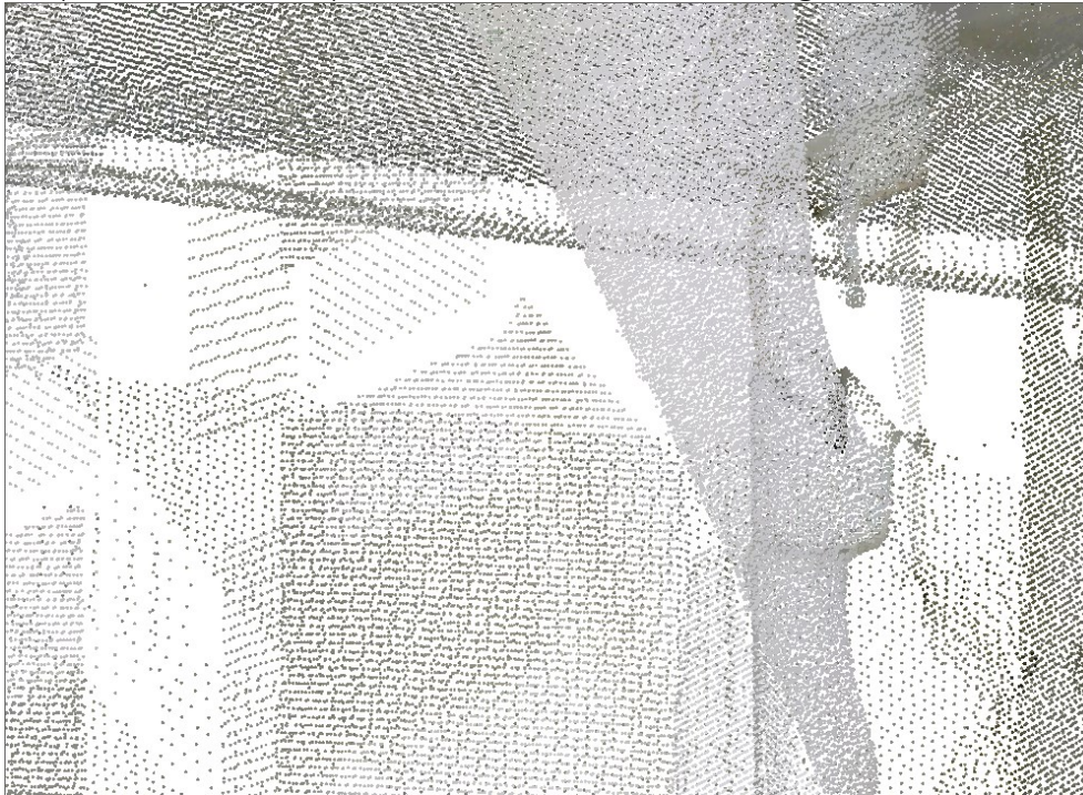
Beispiel einer in HiCAD importierten Punktwolke (Bild: VHV Anlagenbau GmbH, Hörstel)
