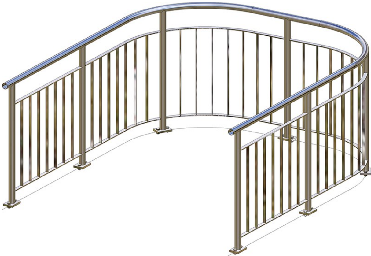
Entlang einer Skizze mit Bögen erzeugtes Geländer
